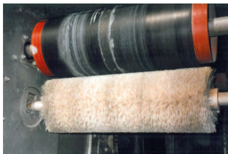
Gurtreinigung mit Reinigungsbürste Belt cleaning with cleaning brush
