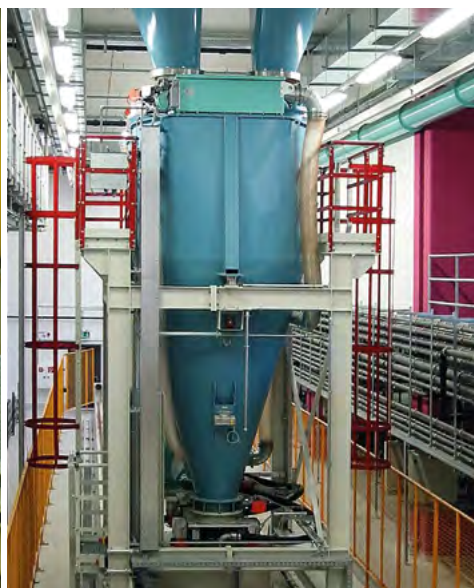
Geschlossene verfahrbare Sand- und Bindemittelwaage Encapsulated movable weighhopper for sand and binder materials
