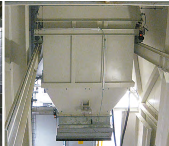
Verfahrbare Waage für nicht staubende Schüttgüter Movable weighhopper for not dust raising materials
