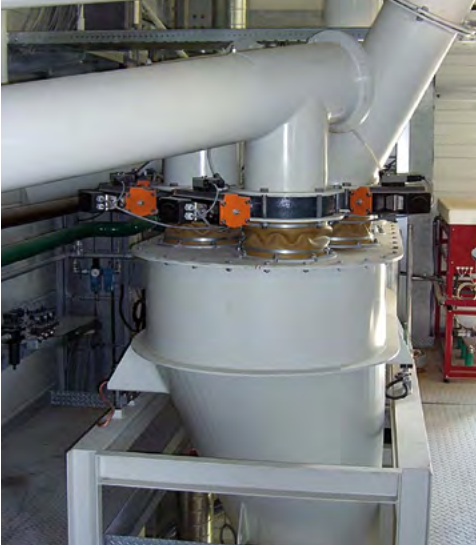
Geschlossene Bauart für staubende Schüttgüter Encapsulated design for dust raising materials
