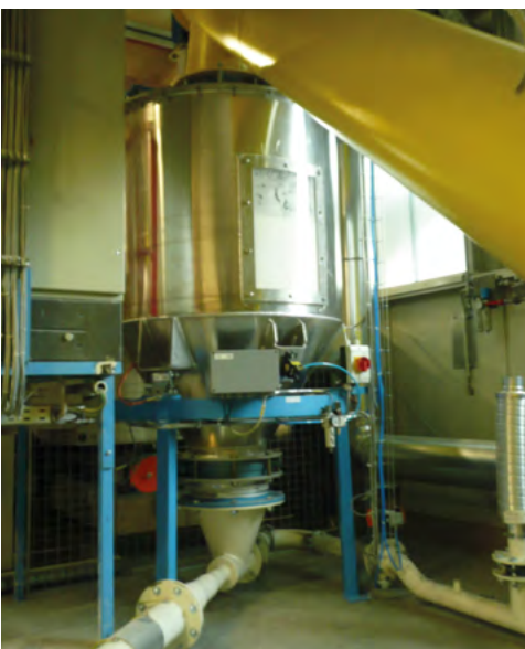
Waage für Leichtzuschlagstoffe für gravimetrische und volumetrische Dosierung Weighhopper for light weight aggregates with gravimetric and volumetric dosing
