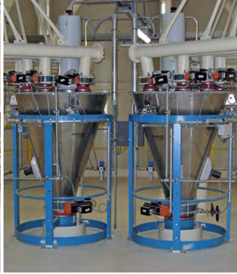
Hochpräzise Dosierung und Verwiegung von chemischen Additiven in einem Trockenbaustoffwerk High precision dosing and weighing of additives in a dry mortar plant
