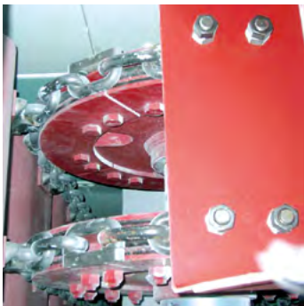
Einsatzgehärtete Ketten mit Becher Case-hardened chains with bucket
